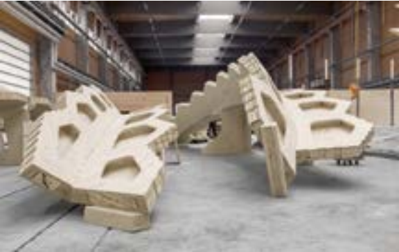
↑ Kaksi teollisuusrobottia valmisti 376 erilaista levysegmenttiä, joissa oli 17.000 erilaista sormiliitosta.
